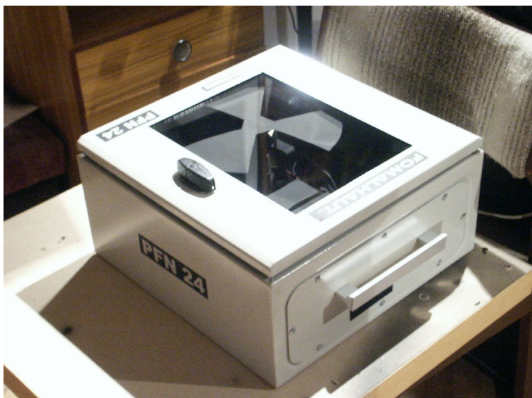
Zdjęcie 1. Stacja bolidowa Fomalhaut 01 zainstalowana w PFN 24 Gniewowo
